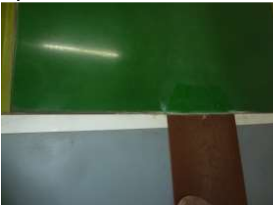
Abrisse am Beginn der Bahn
